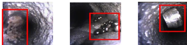
Figura 2 – Alcuni risultati ottenuti applicando Reti Neurali Ricorrenti al rilevamento di scarti di produzione all'interno dei condotti di un motore
